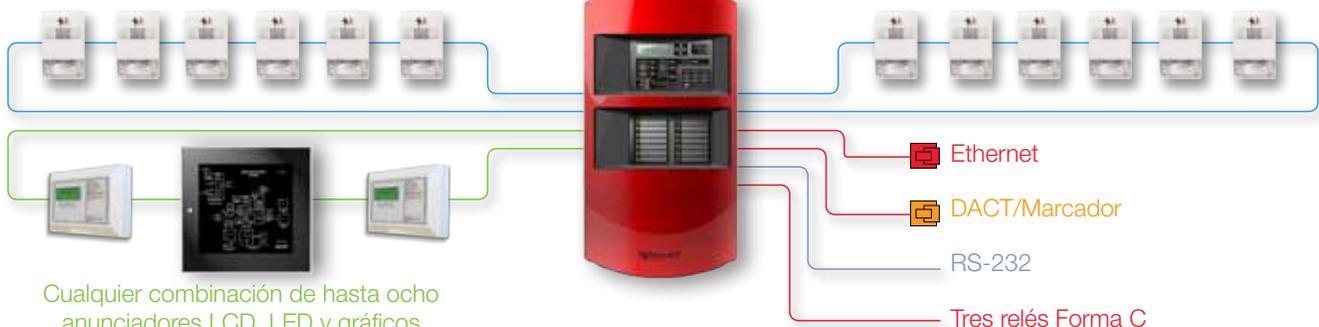
El diagrama representa un sistema VS2 cableado para operación Clase A con un complemento de tarjetas opcionales.
